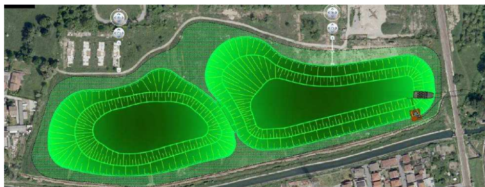
Figura 24-9 configurazione planimetrica dell'invaso di laminazione (fonte: studio AIPO)
