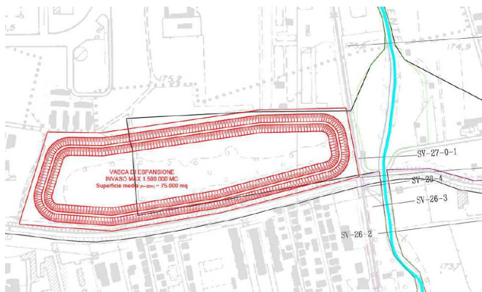
Figura 24-9 configurazione planimetrica dell'invaso di laminazione (fonte: studio AIPO)
