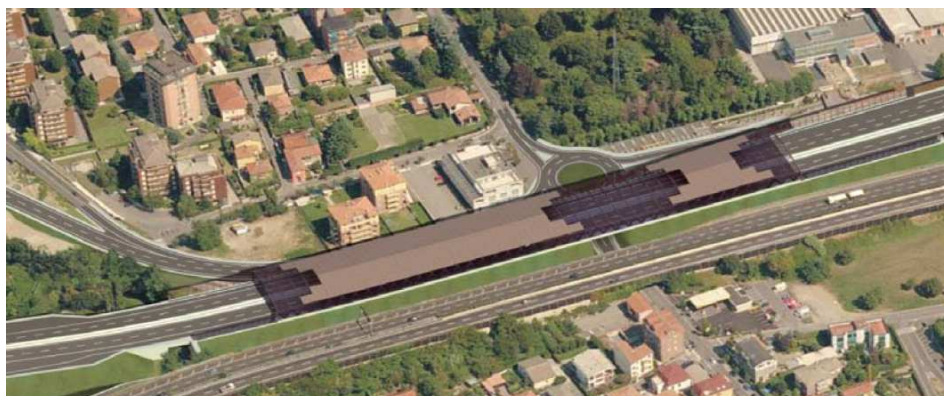
Figura 24-5 rendering di giacitura e galleria fonica (progetto MilanoSerravalle)
